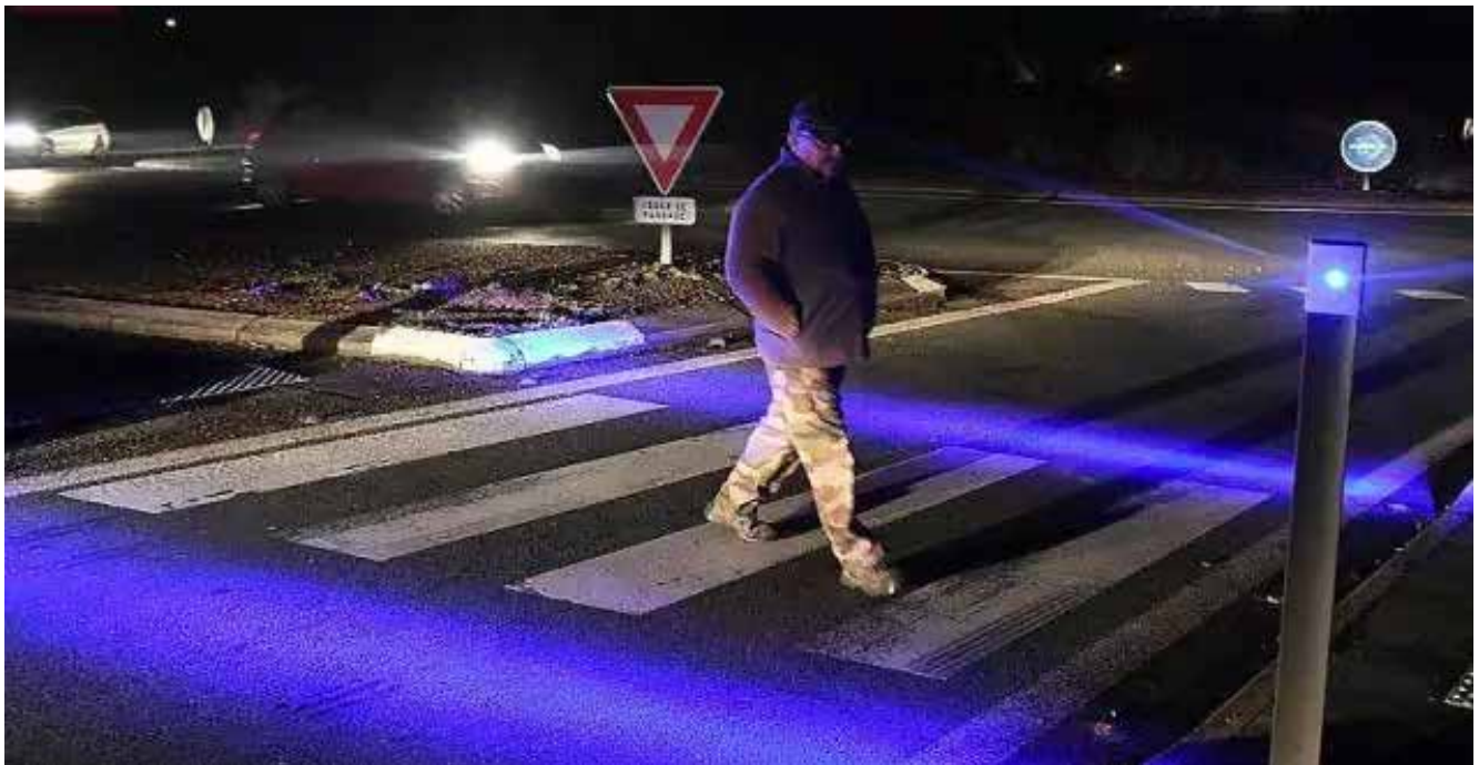
Innovation mondiale dans le domaine de la voirie intelligente : le passage piéton lumineux s'allume via des capteurs de présence pour assurer la sécurité des personnes qui traversent même si l'éclairage public est faible. (Photo: © Photo CO - LAURENT COMBET)
