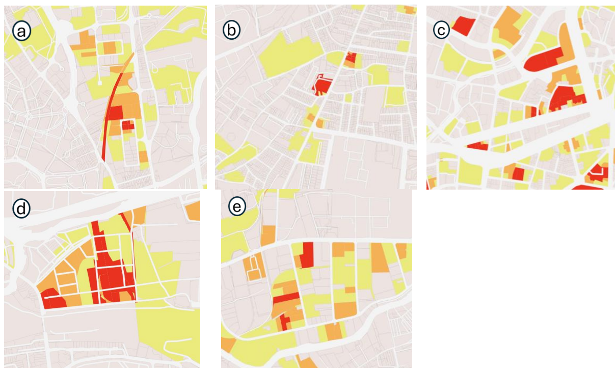
Illustration 59 : Parcelles cadastrales concernées par une ou plusieurs anciennes activités industrielles et de service recensées dans la base de données BASIAS et pression polluante associée selon la méthodologie initiale d'exploitation de la BD ActiviPol du BRGM (2022), d'agrégation des notes (somme d'indices) et de répartition des classes d'aléa (méthode de Jenks)
