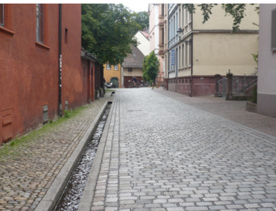
Une rigole à ciel ouvert, un matériau différent définissent les différents usages de la rue. Fribourg
