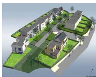
Des organisations urbaines plus économes en espace. La maison individuelle groupée 20 à 25 logements par hectare
